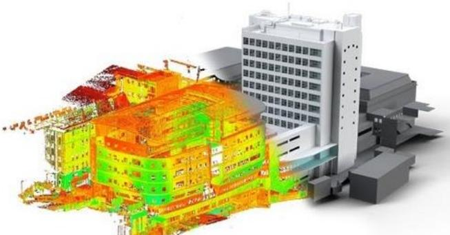
Tijekom procesa laserskog skeniranja potrebno je identificirati referentne točke (repere) koji će se u naknadnoj obradi oblaka točaka snimljenih s nekoliko stanica snimanja koristiti za lakše spajanje nekoliko oblaka točaka u jedinstveni oblak točaka cijele zgrade. Postoje razne tehnike određivanja repera koje se koriste pri laserskom skeniranju, ali najvažnije je naglasiti da je potrebno odrediti barem tri repera na objektu koji se skenira i to na svakoj postaji skeniranja. Naravno
