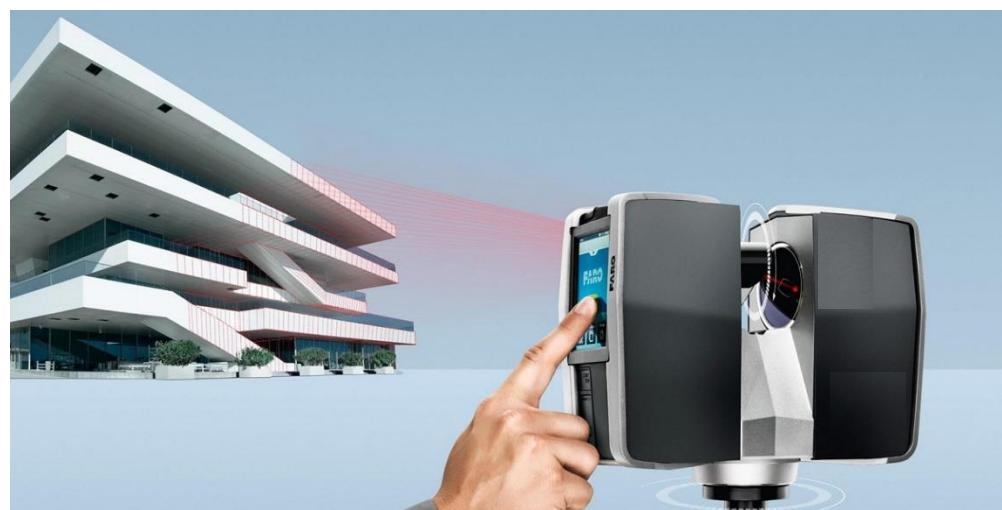
reflektiraju od objekata koji se nalaze u okolini uređaja i ulaze natrag u sam uređaj. Podatak koji se mjeri je zapravo vrijeme potrebno da se laserska zraka vrati u uređaj, te se temeljem poznate brzine širenja (brzine svjetlosti) i vremena povrata zrake može izračunati udaljenost objekta od uređaja. Tu udaljenost bilježi kao točku u nekom trodimenzionalnom prostoru. Ukoliko se odašilje veliki broj laserskih zraka (tisuće u sekundi), dobije se veliki broj točaka
