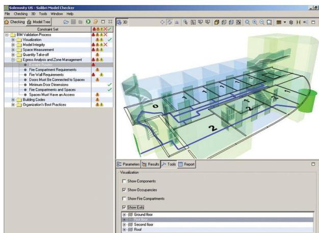
Sva odstupanja od propisa se automatski prikazuju u prozoru koji objašnjava odstupanja kroz slikovni prikaz popraćen tehničkim napomenama. Prikazane su i generičke tehničke napomene te tehničke napomene specifične za relevantni propis s kojim nisu usklađeni promatrani elementi.
